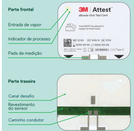
Figura 3. Vistas frontal e traseira do 3M™ Attest™ eBowie-Dick Cartão Teste 10135
