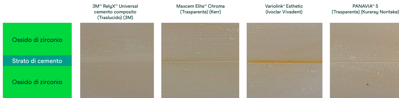
Fig. 14: Discromie negli strati di cemento dopo 24 ore di conservazione in soluzione di caffè.
