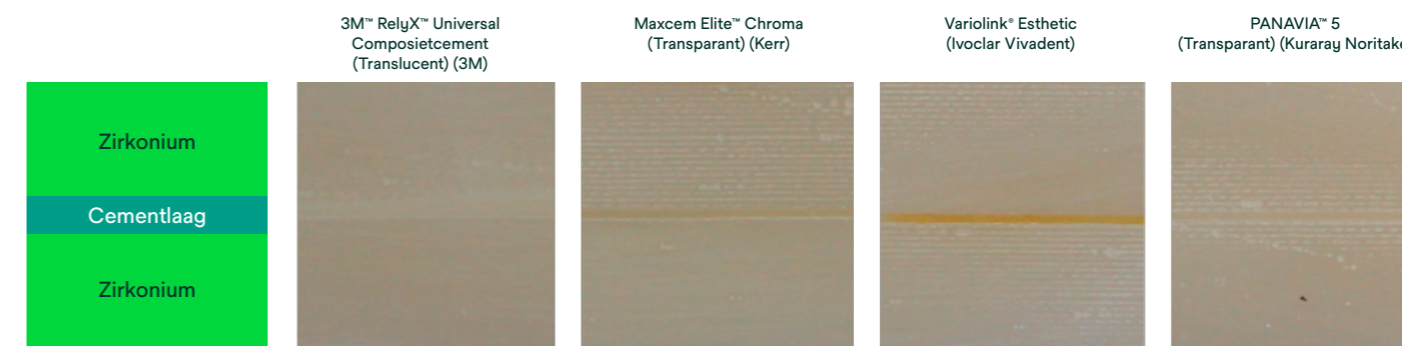
Afb. 14: Verkleuring van cementlagen na 24 uur in koffie-oplossing. Bron: Interne gegevens 3M
