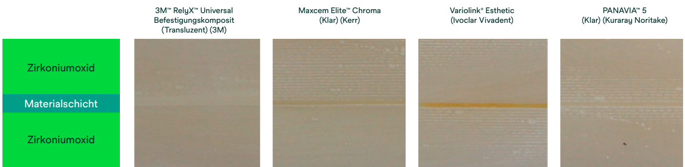
Abb. 14: Verfärbung von Materialschichten nach 24 Stunden Lagerung in Kaffeeauflösung.
